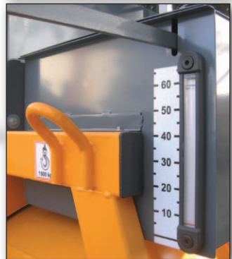
Réservoir d'eau capacité 60 litres avec indicateur de niveau et levier de commande. Raccord d'eau pour remplissage situé de l'autre côté du tableau de commande.
